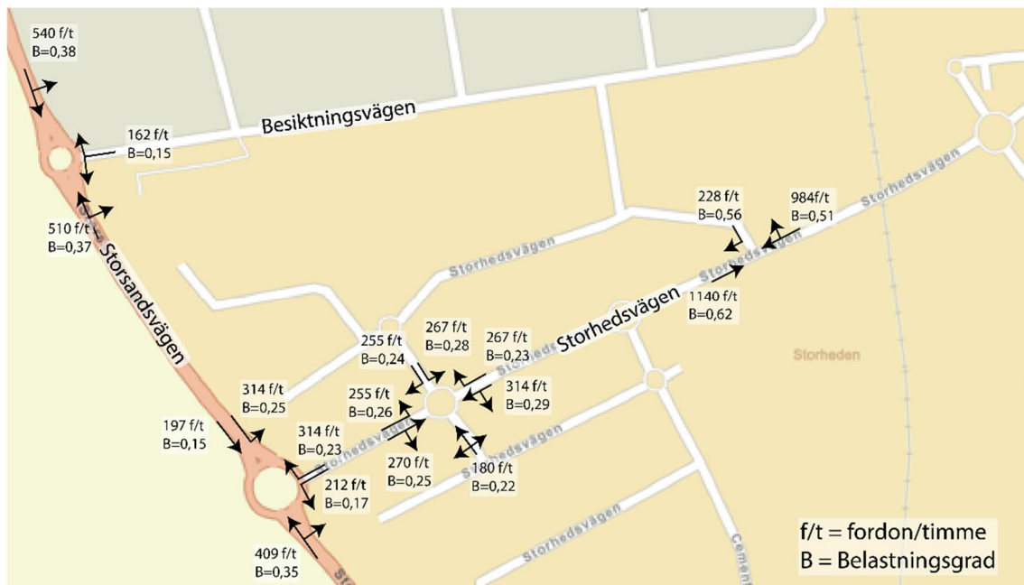
Figur 8. Flöden och belastningsgrader i maxtimmen.
