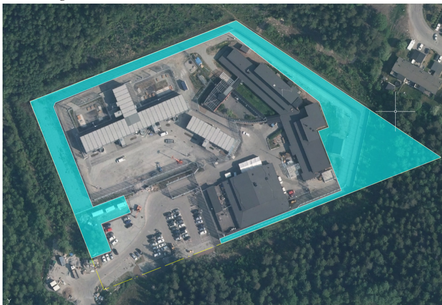
Bild 1: I bilden är markytor som bedöms vara genomsläppliga för dagvatteninfiltration utmarkerade i blått. Det gäller främst grusade och vegetationsbeklädda markytor.
