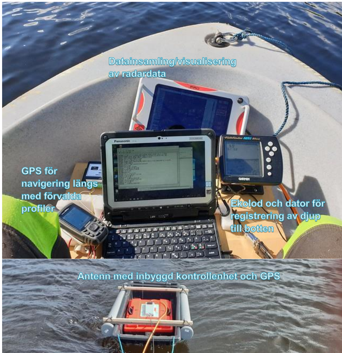
Figur 4. Foto över radarutrustningen MALÅ EL Pro WideRange HDR, samt ekolodsutrustning.
