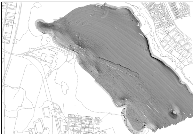
Bild 8. Side scan sonar-mosaik draperad på multibeamdata.
