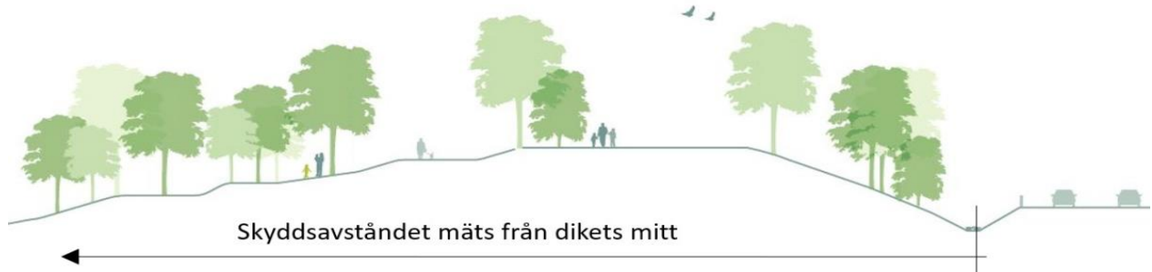
Figur 5. Illustration av hur angivet skyddsavstånd ska mätas då det finns dike (Länsstyrelsen i Norrbottens och Västerbottens län, 2019).
