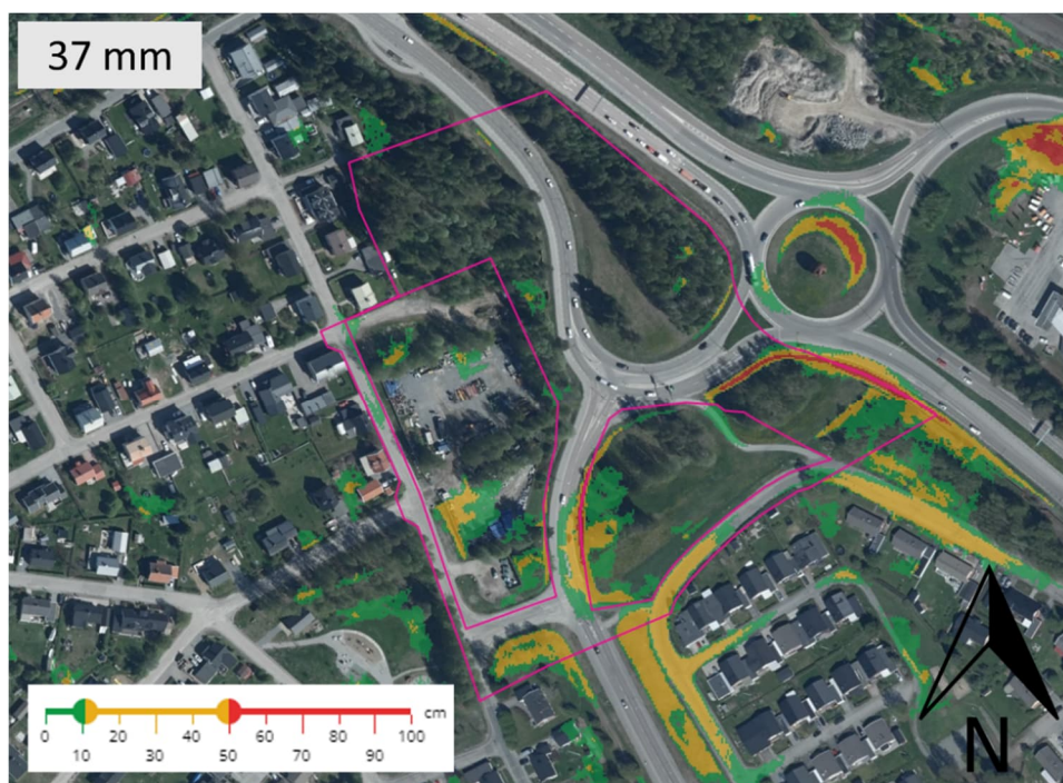
Figur 11. Översvämningsutbredning och översvämningsdjup vid ett 100-årsregn med klimatafaktor 1,25 (37 mm nederbörd). Översvämningsdjupet inom planområdet uppgår till maximalt 1 meter i befintligt vägdike. (Scalgo Live, 2022).
