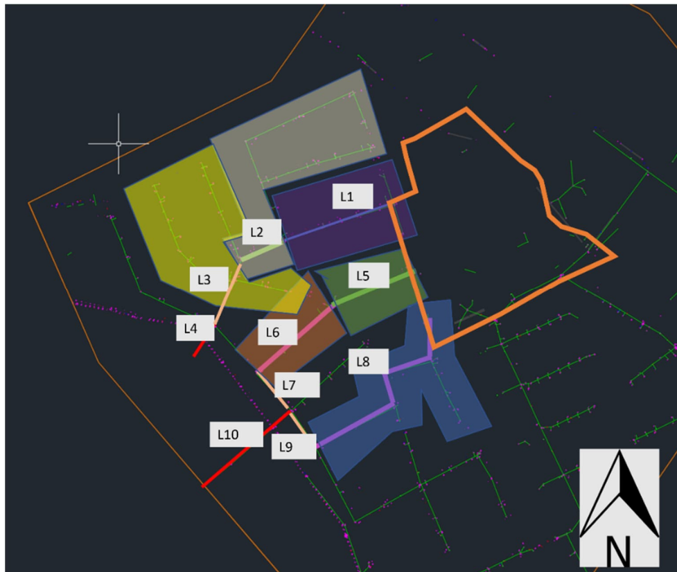
Figur 13. Befintligt ledningsnät som avvattnar planområdet mot Notviken. Planområdet är utritat i orange och uppskattade tekniska avrinningsområden för olika ledningssträckor är också utmarkerade. (Ledningskollen, 2022)
