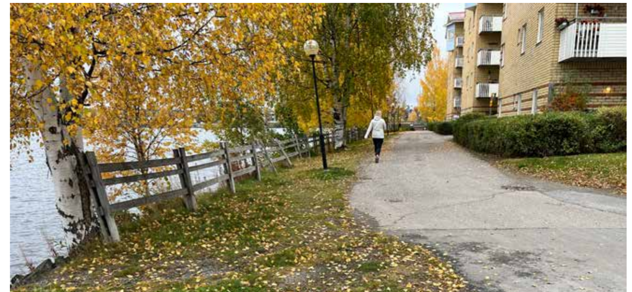
Befintligt trasigt staket längs strandpromenaden. Asfalten ersätts av en ny stenmjölsgång med mjukare draging.
